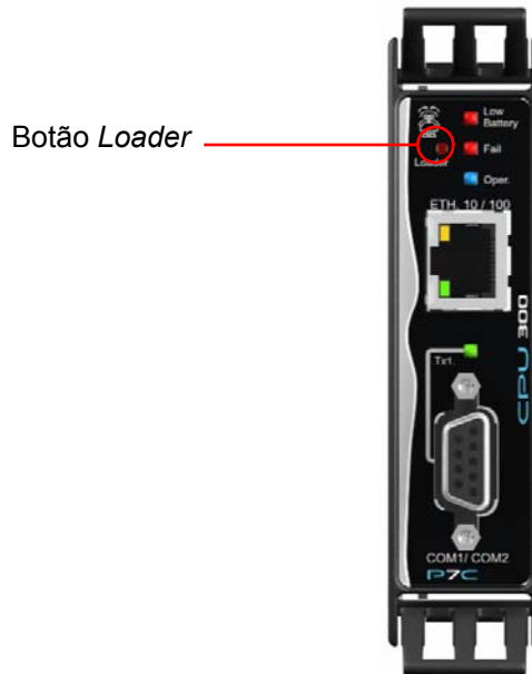
Figura 4: Localização do botão Loader nos Controladores P7C (Módulo CPU300)
